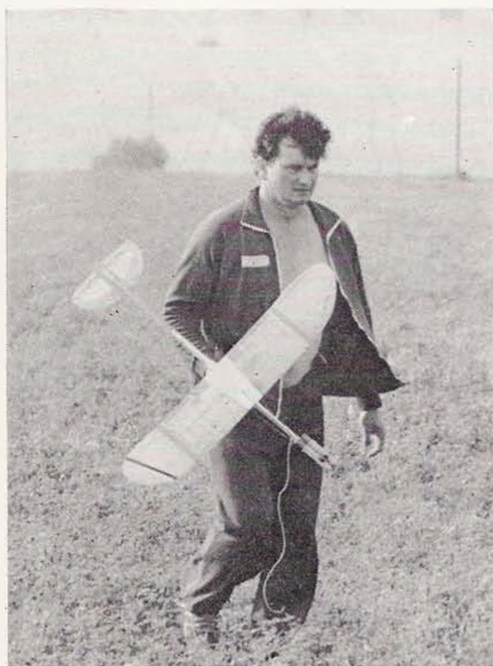
▲ RC polomaketa víceúčelového letounu Pílatus Porter L. Párala z Městské stanice mladých techniků v Praze 8 o rozpětí 1400 mm a hmotnosti 1600 g je poháněna motorem MVVS 2,5. Rádiová souprava Modela Digi ovládá výškovku, směrovku a otáčky motoru
