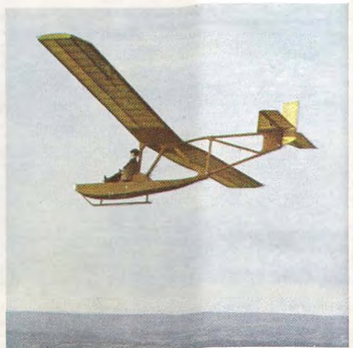
► RC polomaketa školního kluzáku SG-38, zachycená krátce po startu ve francouzské Bretani, má rozpětí 2,3 m
