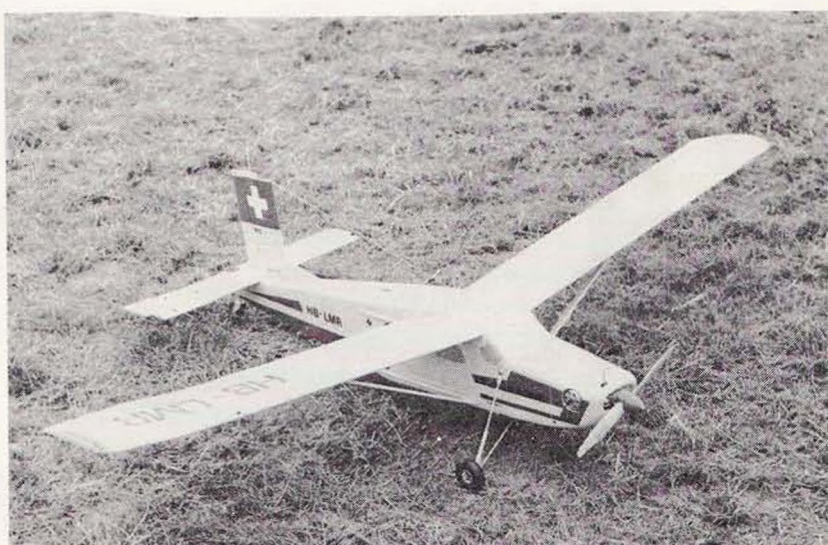
▲ RC polomaketa víceúčelového letounu Pílatus Porter L. Párala z Městské stanice mladých techniků v Praze 8 o rozpětí 1400 mm a hmotnosti 1600 g je poháněna motorem MVVS 2,5. Rádiová souprava Modela Digi ovládá výškovku, směrovku a otáčky motoru
